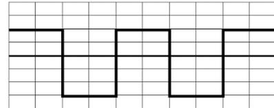
Com o osciloscópio calibrado em 3 Volts/divisão na escala vertical e 2 ms/divisão na escala horizontal, verifica-se, pela imagem, que o sinal é uma onda quadrada com, aproximadamente,
